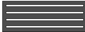
▲ B형 최소 2개 이상의 보강 강판을 탄성 중합체로 완전히 덮은 적층 탄성 받침
